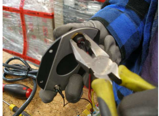
8. Schrauben Sie die Unterbrechermutter ab
