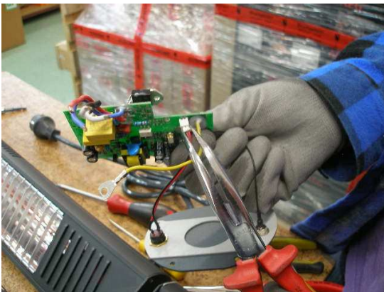
9. Demontieren Sie den Antennenstecker der BT-Leiterplatine
