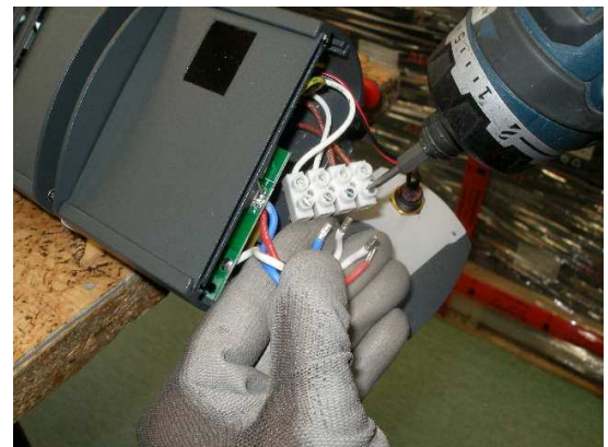
4. Schrauben Sie die Drähte der BT-Platine ab
