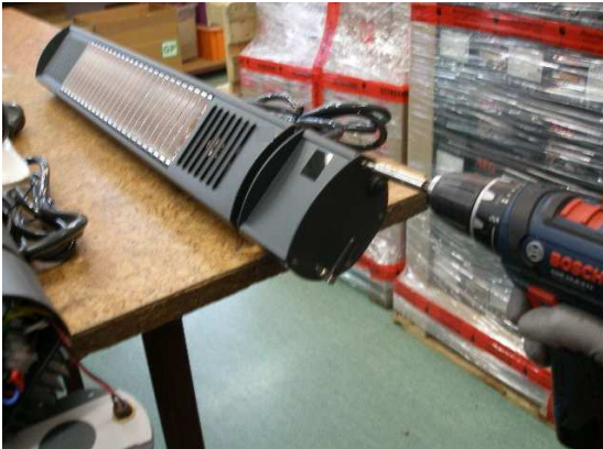
1. Entfernen Sie die 4 Schrauben im Seitenelement
