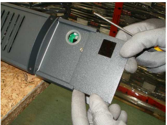
5. Entfernen Sie vorsichtig die Platte mit Glas
