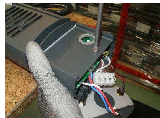
6. Entfernen Sie die Triac (Symistor) Schraube
