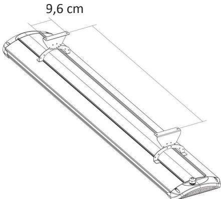
1. À l'aide d'une perceuse, réaliser quatre trous dans le mur comme indiqué dans l'illustration.
