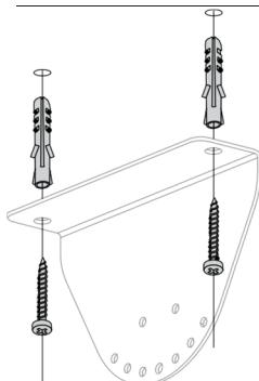
2. Die beiden Halterungen mit großen Löchern an der Wand befestigen. Dazu Schrauben und Dübel geeigneter Größe verwenden.
