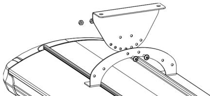
I supporto da fissare al muro presenta una serie di fori che permettono di fissare il riscaldatore in 6 diverse posizioni.
