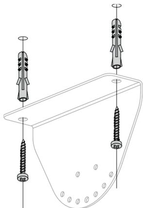
2. Fixer sur le mur les deux supports dotés de grands trous en utilisant des vis et des chevilles de dimensions appropriées.
