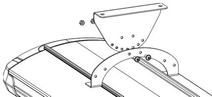
Die an der Wand oder Decke zu befestigende Halterung weist eine Reihe an Löchern auf, die eine Befestigung des Heizstrahlers in 6 verschiedenen Positionen ermöglichen.
