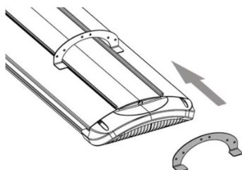
**3.** Insérer le support à arc dans le rail adéquat de la partie supérieure de l'appareil.
