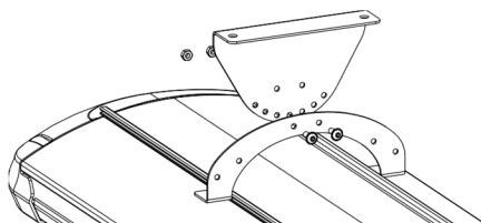
Le support à fixer au mur comporte une série de trous qui permettent de fixer le radiateur dans 6 positions différentes
