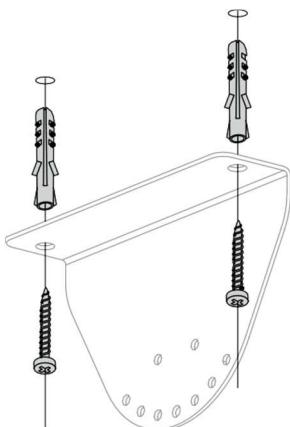
*Assicurarsi che il muro a cui si intende fissare l'apparecchio sia solido e che al suo interno non passino condutture elettriche o tubi dell'acqua.*
